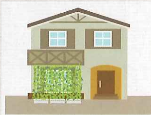
2階のバルコニーにネットを固定
